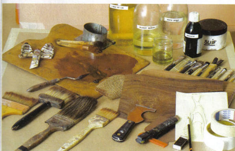
OUTILS (de gauche à droite et de haut en bas) Palette avec pinceaux brécheurs, diluants, toile à chiffonner, exemples d'essences avec veinages, pinceaux, spalter, couteaux, cutter, gomme, crayon, feuille de dessin, scotch.
